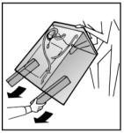
Вставьте заглушку (она находится в пакете вместе с инструкцией) в отверстие на задней панели машины.
